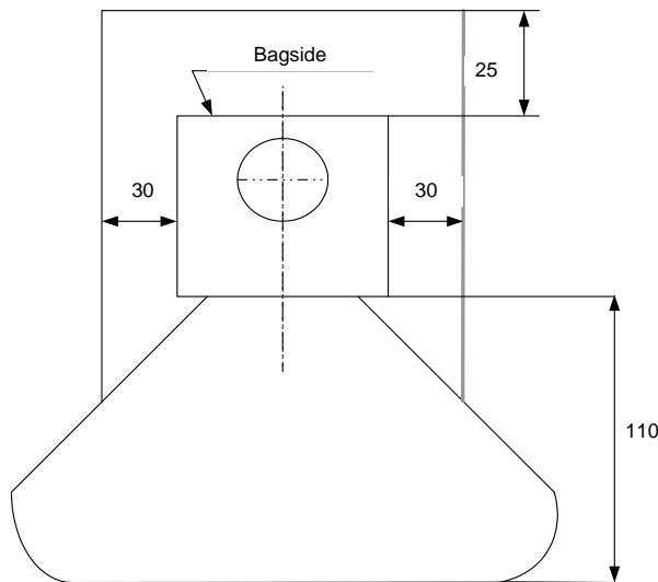
Der er mulighed for at reducere afstanden til brændbart materiale, hvis der isoleres med minimum 5,0 cm isolering med samme egenskaber som Aduro Superisol, Isolrath 1000 eller lignende materiale omkring Aduro 5-1. Vær dog opmærksom på, at der fortsat skal være 2,5 cm luft rundt om pejseindsatsen. Dette betyder, at afstanden til brændbart materiale kan reduceres til 7,5 cm (2,5 cm luft rundt om indsatsen + 5 cm isolering).
