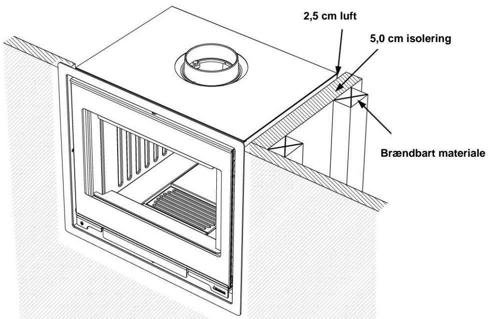
Bemærk: at pejseindsatsen skal installeres på et golv med tilstrækkelig bæreevne. Hvis den eksisterende konstruktion ikke opfylder denne forudsætning, skal der foretages passende foranstaltninger (fx belastningsfordelende plade) for at opnå dette.
