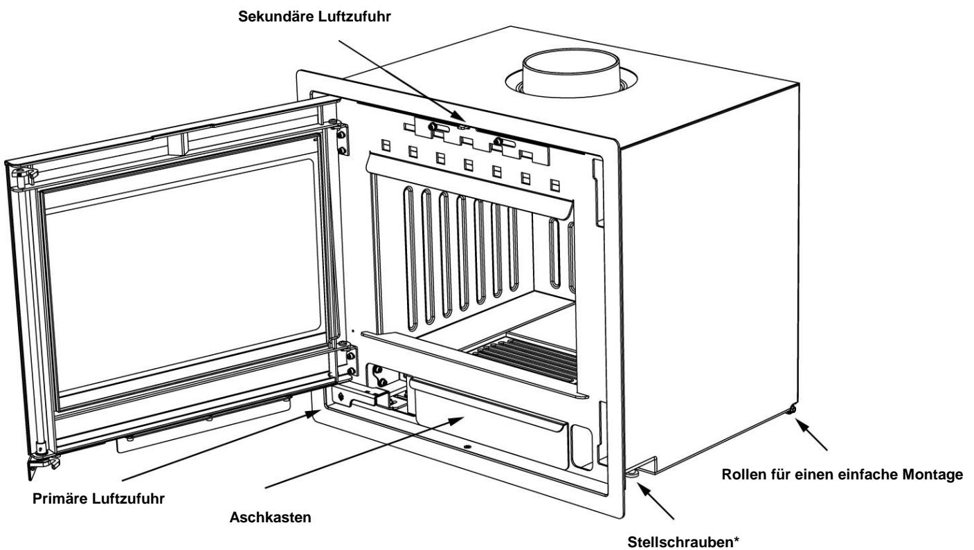
\* Vergessen Sie nicht die Stellschrauben zu montieren, bevor Sie den Kamineinsatz am gewünschten Ort platzieren. Die Stellschrauben liegen im Aschkasten.
