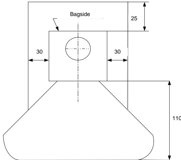
Es ist möglich den Abstand zu brennbaren Materialien zu reduzieren, Sie können mit mind. 5 cm starken Isolierungsplatten mit denselben Eigenschaften wie z.B. Aduro Superisol, Isolrath 1000 oder Ähnlichem um den Ofen herum isolieren. Bitte stellen Sie jedoch sicher, dass es mind. 2,5 cm Freiraum um den Aduro 5-1 gibt. Dies bedeutet, dass der Abstand zu brennbaren Materialien auf 7,5 cm reduziert werden kann (2,5 cm Freiraum um den Ofen + 5 cm Isolierung).
